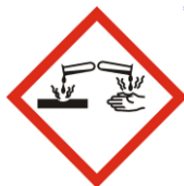
(GHS05 : Matière corrosive)
