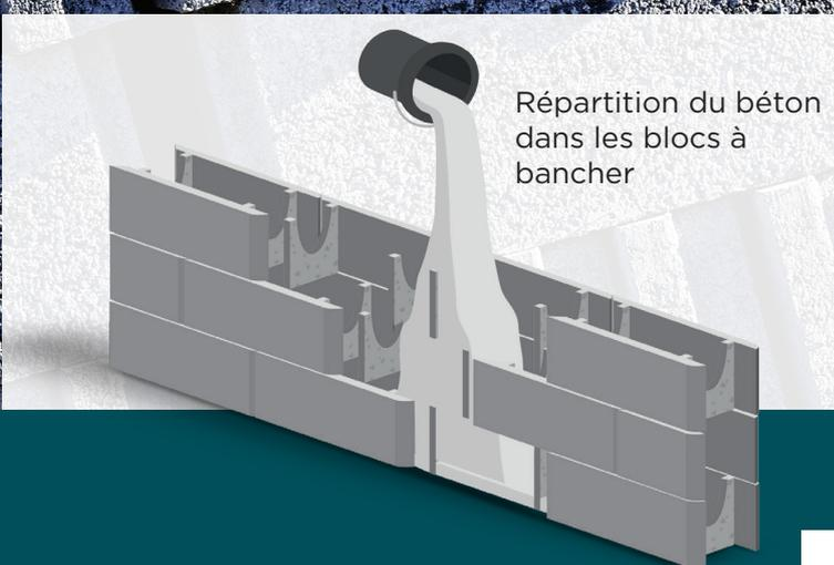
Répartition du béton dans les blocs à bancher
